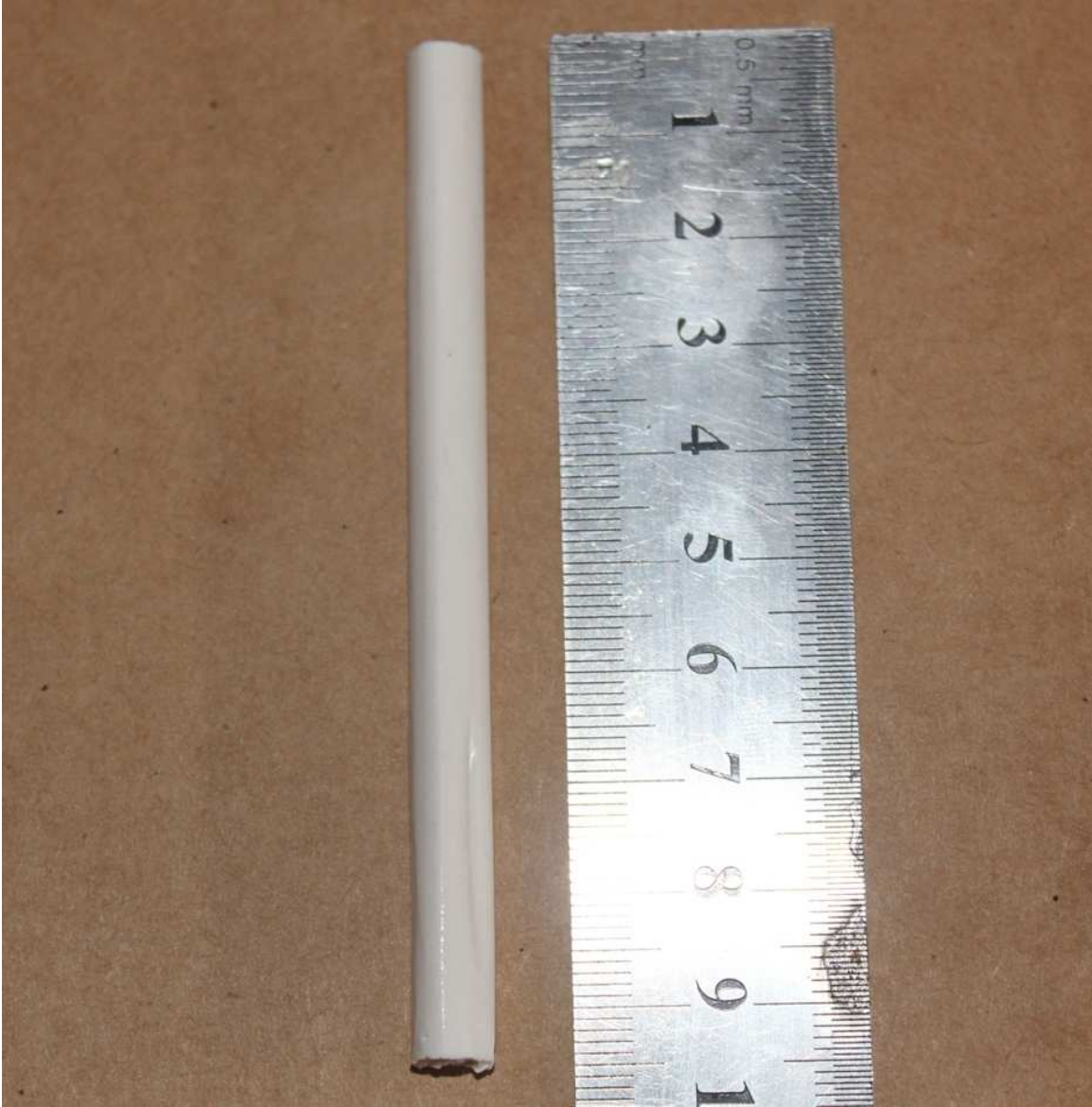
Fig. 3 Cast KNO_3 - NaNO_3 -Mannitol propellant strand
